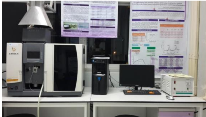
ภาพ 32 เครื่องเฟลมอะตอมมิกแอฟซอร์พชันสเปกโทรมิเตอร์ (FAAS), รุ่น SpectrAA 240FS, Varian, Australia
