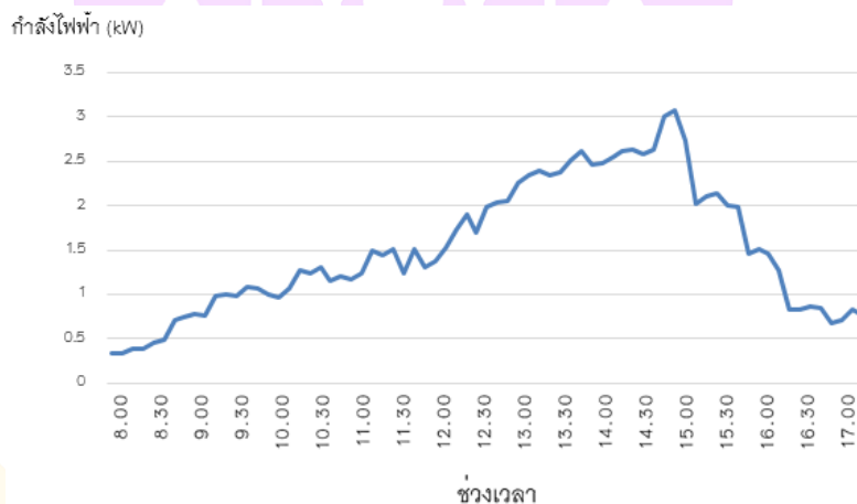
ภาพ 28 ค่าเฉลี่ยกำลังไฟฟ้าที่ผลิตได้จากโซลาร์เซลล์ขนาด 5 กิโลวัตต์
