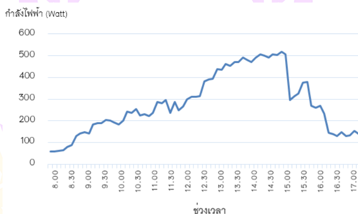
ภาพ 26 ค่าเฉลี่ยกำลังไฟฟ้าที่ผลิตได้จากโซลาร์เซลล์ขนาด 1 กิโลวัตต์
