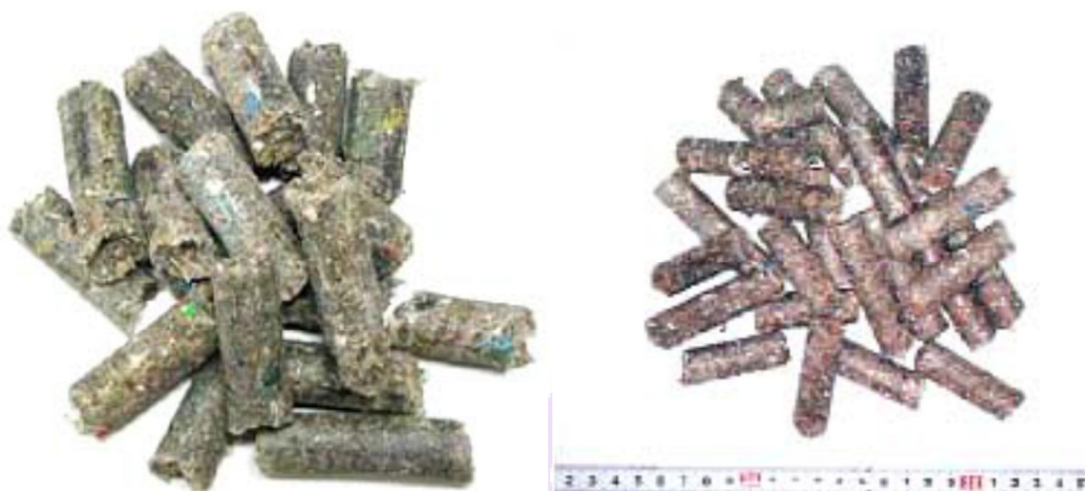
ภาพ 5 แสดงแท่งเชื้อเพลิงขยะDensified RDF หรือ RDF5 หรือเรียกว่า d-RDF
