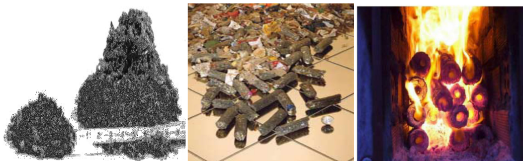
ภาพ 4 แสดงการนำขยะที่เผาได้ไปบดและอัดเป็นแท่งเชื้อเพลิง RDF ก่อนนำไปใช้เป็นเชื้อเพลิงในการเผาไหม้
