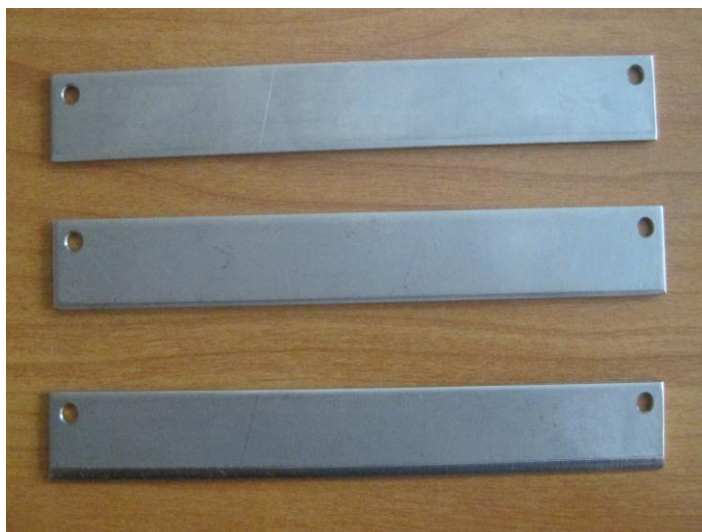
ภาพ 47 SUPPORT SHAFT ที่ได้จากการนำสแตนเลส มา Reuse
